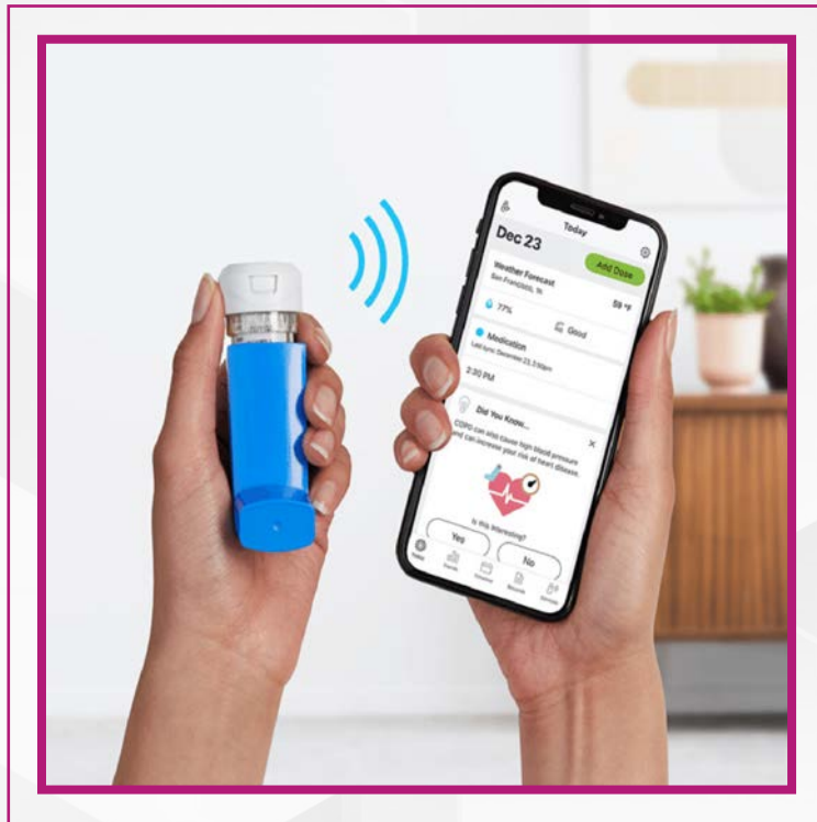
Figura 12. Inhalador que se conecta vía bluetooth a un teléfono inteligente para dar seguimiento al tratamiento.
